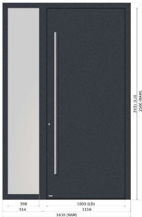
Bild 1: Außentür (oder gleichwertig)
