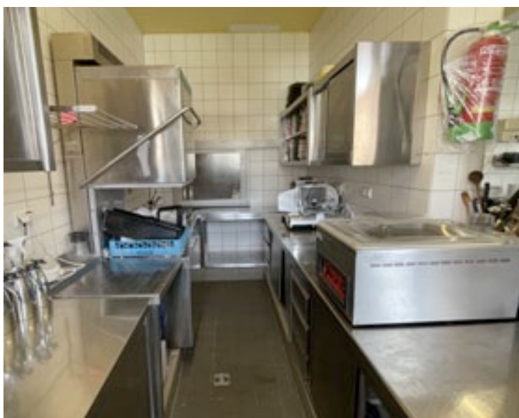
Geschirrrückgabe und Haubenspülmaschine von Hobarts
