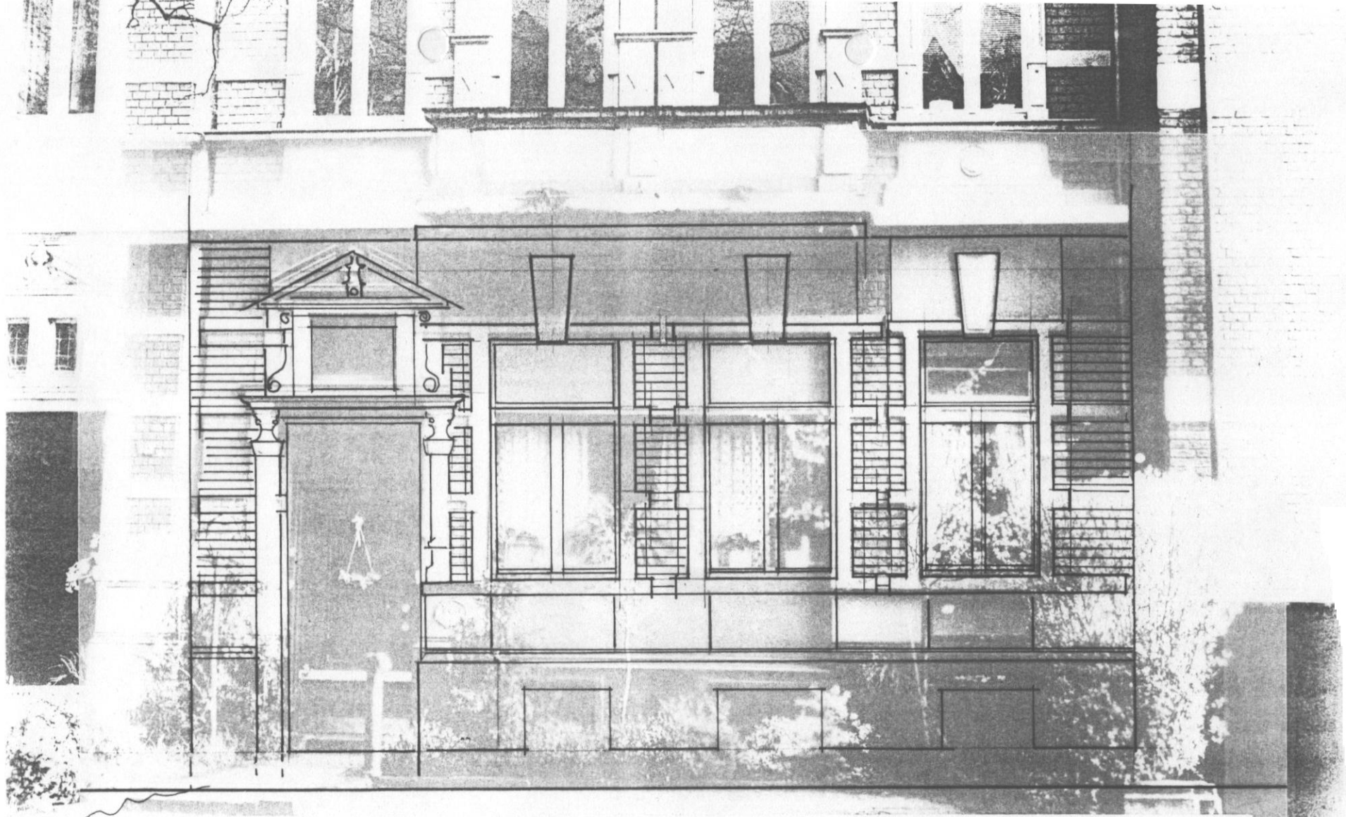
Rekonstruktion der Erdgeschoßfassade am Baudenkmal Uerdinger Str. 341
