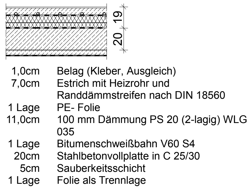
Fußbodenaufbau Erdgeschoss
