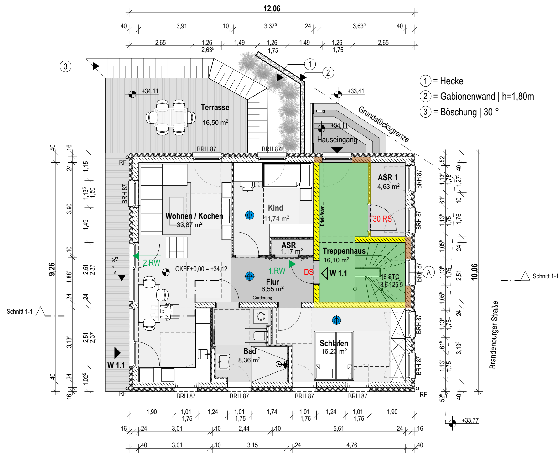
Grundriss-Erdgeschoss | Neubau Haus 1
