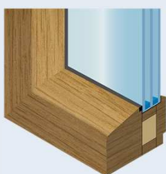
Drei-Scheiben-Holzfenster mit Kerndämmung
