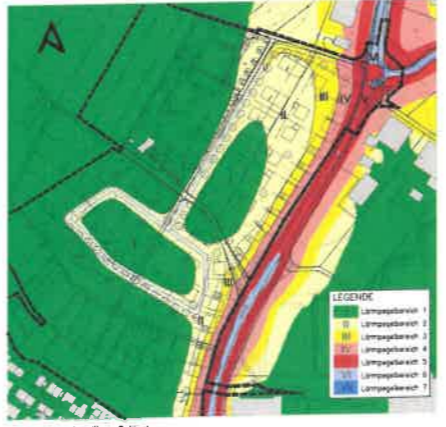
Rechenhöhe 4m über Gelände
