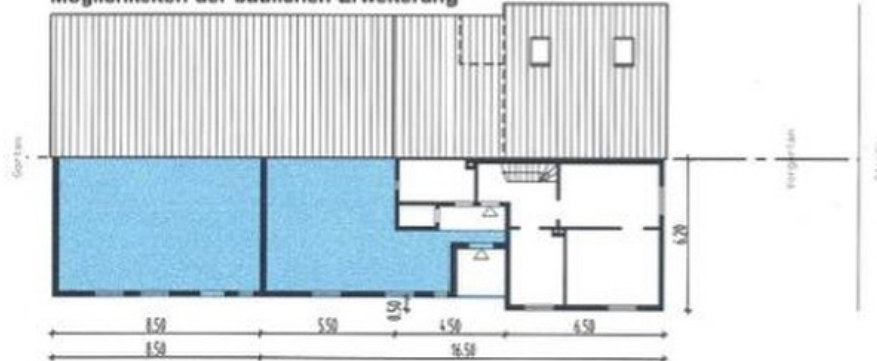
Seitliche Ansicht nach Erweiterung
