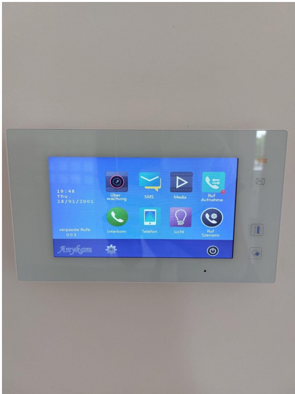
Videoanlage mit Chipöffnung
