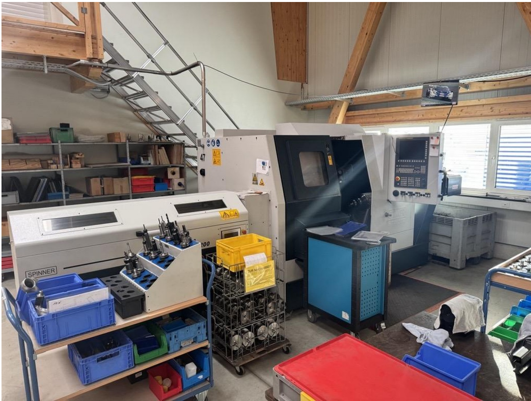
CNC drehen 2 Stangenzuführer
