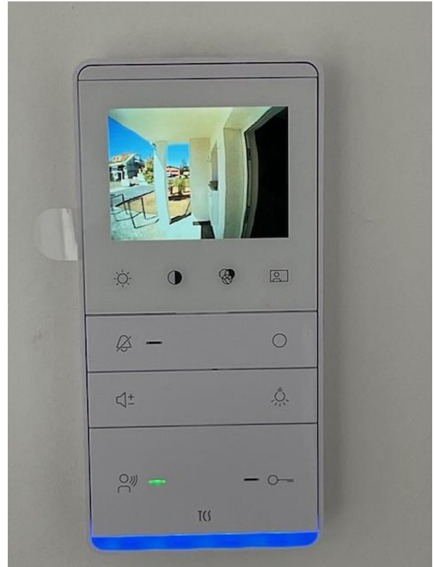
Sprechanlage mit Kamera
