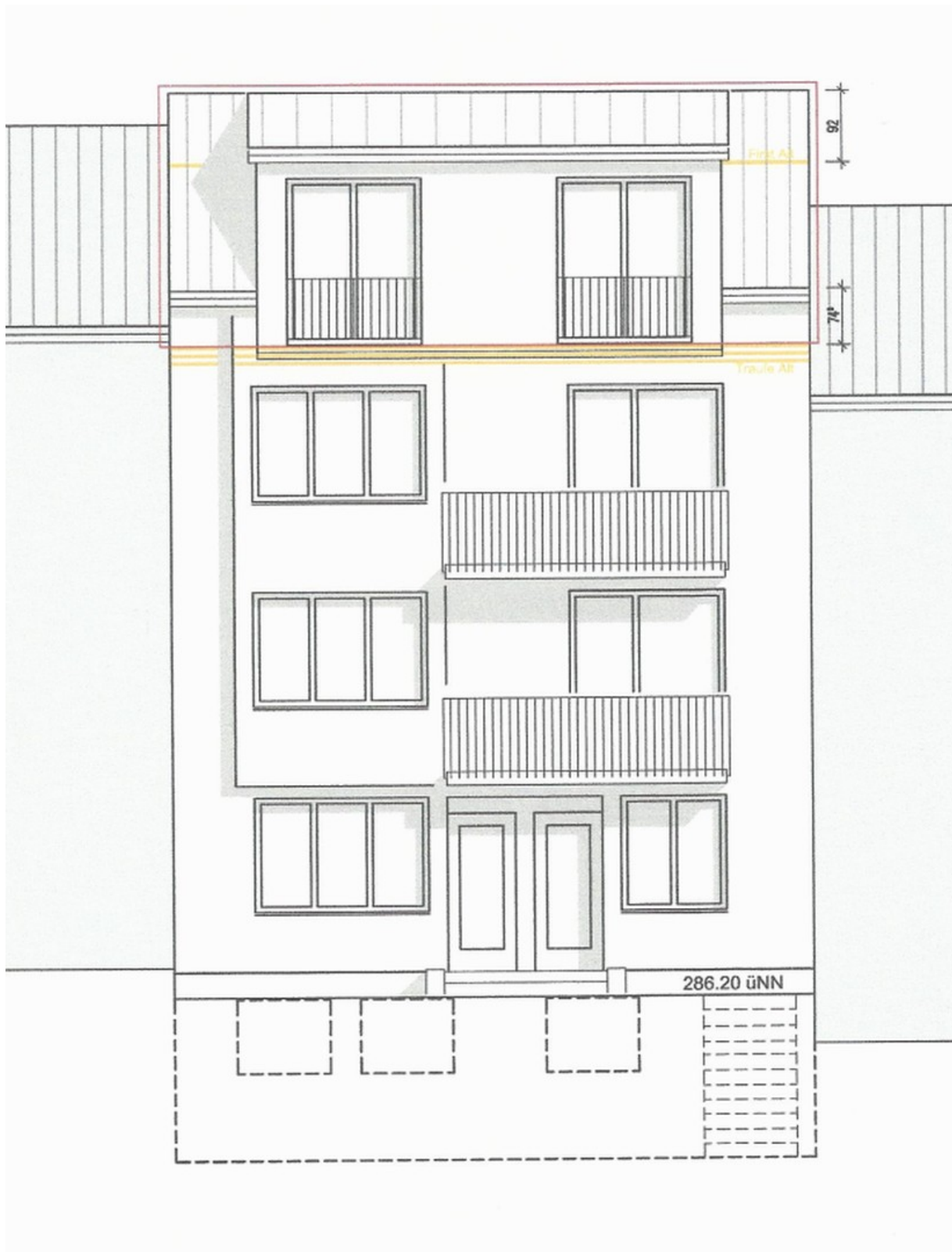
Rückseite mit neuem DG
